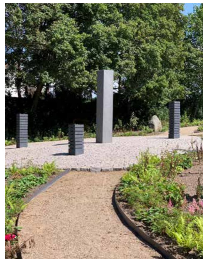
Den store søjle er lavet i Blå Rønne og er jetbrændt på alle synlige flader og måler 40x40x250 cm. Mindesøjlerne er lavet i satineret Blå Rønne og måler 29x29x24 cm. Brosten og chaussese-ten er Moselykke.
